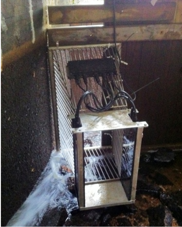
Kuva 2. VAKI -kalalaskuri asennettuna Koivukosken kalatiessä (kuva Ari Haikonen).
