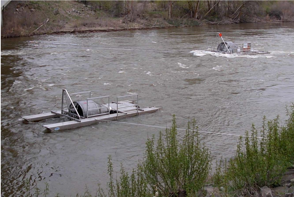
Kuva 7. Kaksi rinnakkain pyynnissä olevaa vaelluspoikasruuvia. Kuva: Michael Rayton
